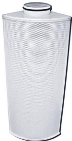
Круглые воздухораспределители низкоскоростные 1ВНУ предназначены для подачи воздуха непосредственно в рабочую зону помещения с малой скоростью и малым температурным перепадом ( $\Delta t = 3^\circ\text{C}$ ), обеспечивающими принцип вытесняющей вентиляции.
