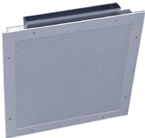
Встраиваемые воздухораспределители низкоскоростные 2ВНВ предназначены для подачи воздуха непосредственно в рабочую зону помещения с малой скоростью и малым температурным перепадом ( $\Delta t = 3^\circ\text{C}$ ), обеспечивающими принцип вытесняющей вентиляции.
