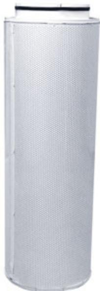
Круглые воздухораспределители низкоскоростные 1ВНК предназначены для подачи воздуха непосредственно в рабочую зону помещения с малой скоростью и малым температурным перепадом ( $\Delta t = 3^{\circ}\text{C}$ ), обеспечивающими принцип вытесняющей вентиляции.
