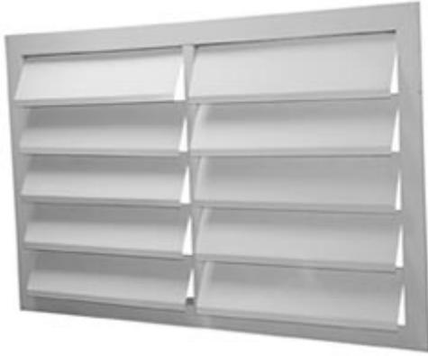
Инерционные решетки АГС предназначены для установки в системах вентиляции и используются как обратный воздушный клапан для автоматического перекрытия отверстий при выключении вентилятора.
